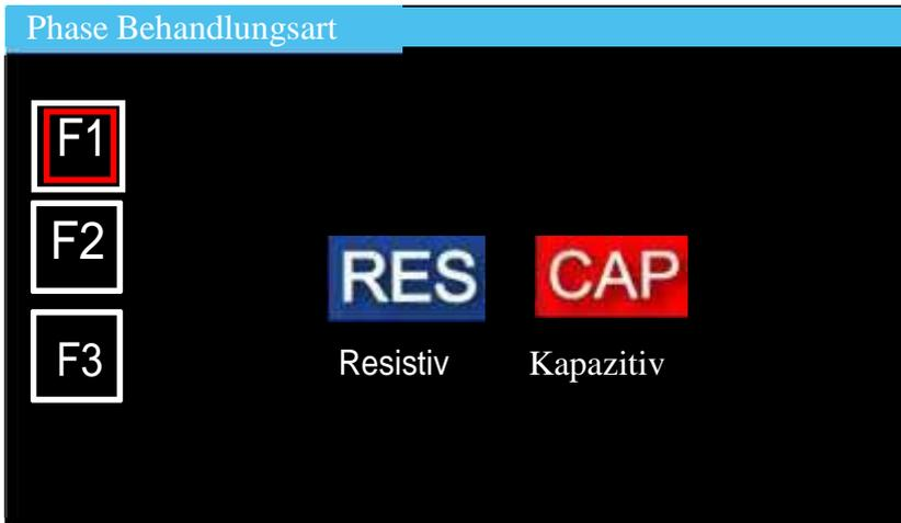
Für jede der Phasen können Sie wählen, ob Sie den kapazitiven oder den resistiven Modus verwenden und die Frequenz und die Phasendauer einstellen.
