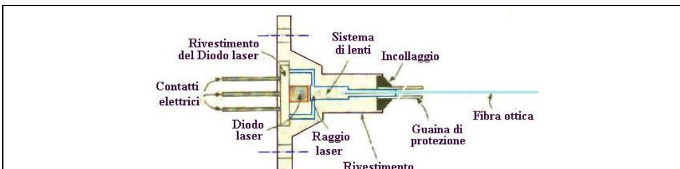
Abbildung a: Umrissstruktur einer Laserdiode.
